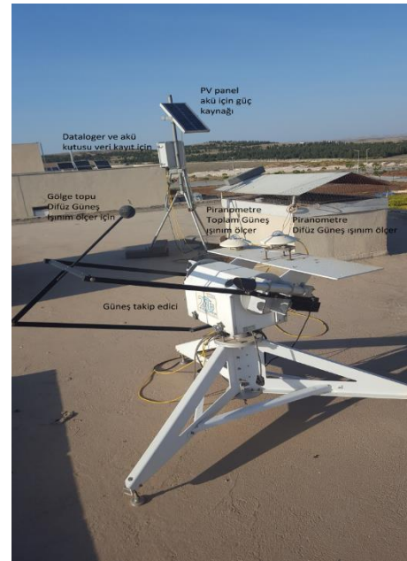
Şekil 1. Güneş Takip Sistemli Güneş Işınım Ölçüm Sistemi (Solar Radiation Measurement System With Solar Tracking System)
