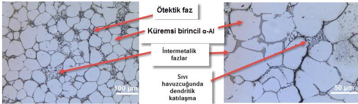
Şekil 7. Reo-dökümle üretilmiş AA7075 alüminyum alaşımının mikroyapısı (The microstructure of reo-cast AA7075 aluminum alloy)
