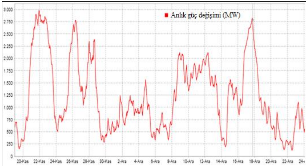
Şekil 10. RES'lerde gerçekleşen örnek bir elektrik üretim profili (Example electricity production profile in the RESs)
