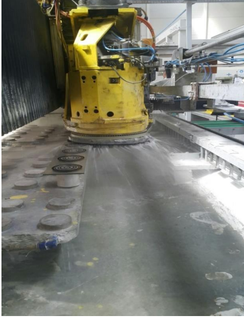
Şekil 1. Düz camın taşlanması
