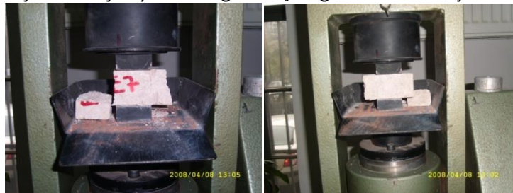
Şekil 14. Eğilmede kırılan parçalar üzerinde yapılan basınç dayanımı deneyi.
