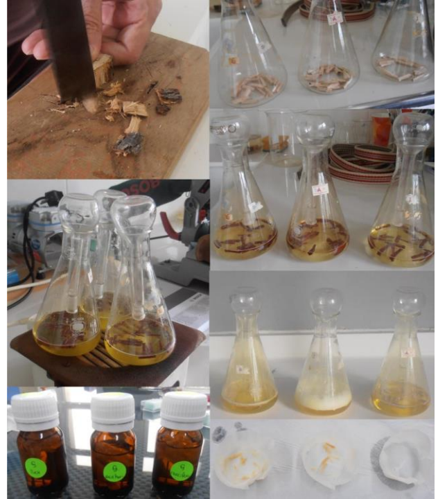
Şekil 3. Meşe odun elemanlarının serbest hale getirilmesi (Maserasyon Yöntemi)
