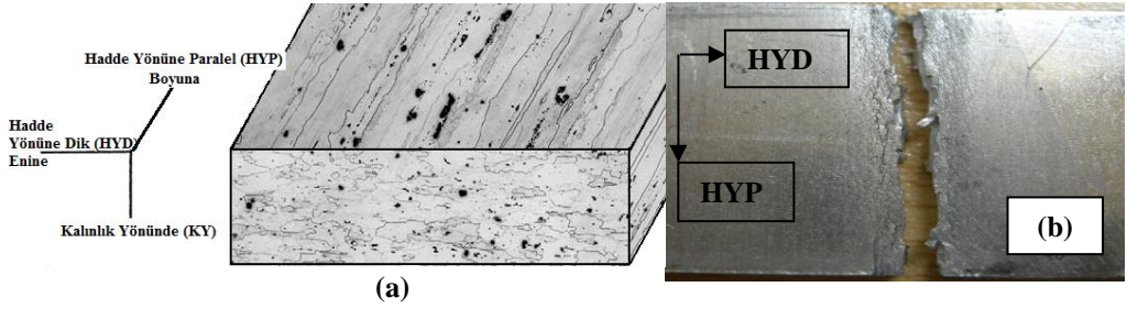
Şekil-1 a) Numuneler için farklı tekstür yapısı (HYP, HYD) ve şematik mikro tane yapısı, b) Hadde yönüne dik (HYD) kırılmış AA1100 alüminyum numune
