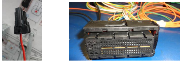
Şekil 5. Tek gözlü ve 105 gözlü soket örnekleri
