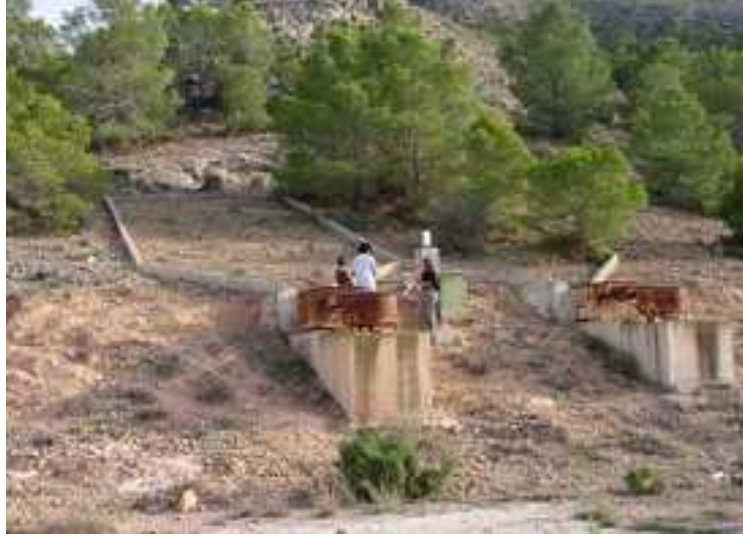
Şekil 1. Bitki örtüsünün etkisini belirlemek için tesis edilmiş yüzeysel akış parselleri (Boix-Fayos et al. 2006).
