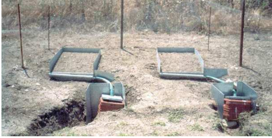
Şekil 8. Tel örgü ile çevrilerek korunmaya alınmış yüzeysel akış parselleri (Valmis et al., 2005).
