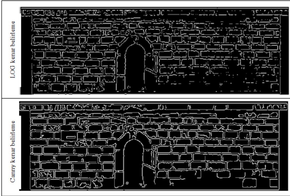
Şekil 11. LOG ve Canny Kenar Algılama Algoritmaları Uygulanmış Görüntüler
