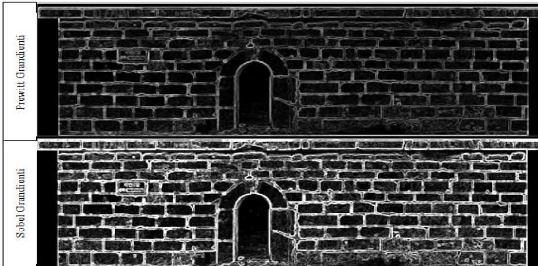
Şekil 9. Prewitt ve Sobel Gradyanının G_x + G_y Yönünde Oluşan Görüntüleri
