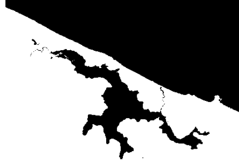
Şekil 4. NIR Bant Kullanılarak Üretilen İkili Görüntü
