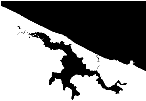
Şekil 3. R, G, B, NIR Bantları Kullanılarak Üretilen İkili Görüntü
