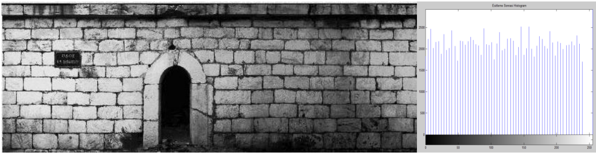
Şekil 3. Histogram Eşitlemesi Sonrası Oluşan Görüntü ve Histogramı
