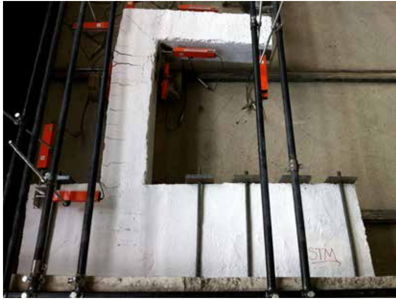
Şekil 10. STM numunesinin göçme anındaki görünüşü
