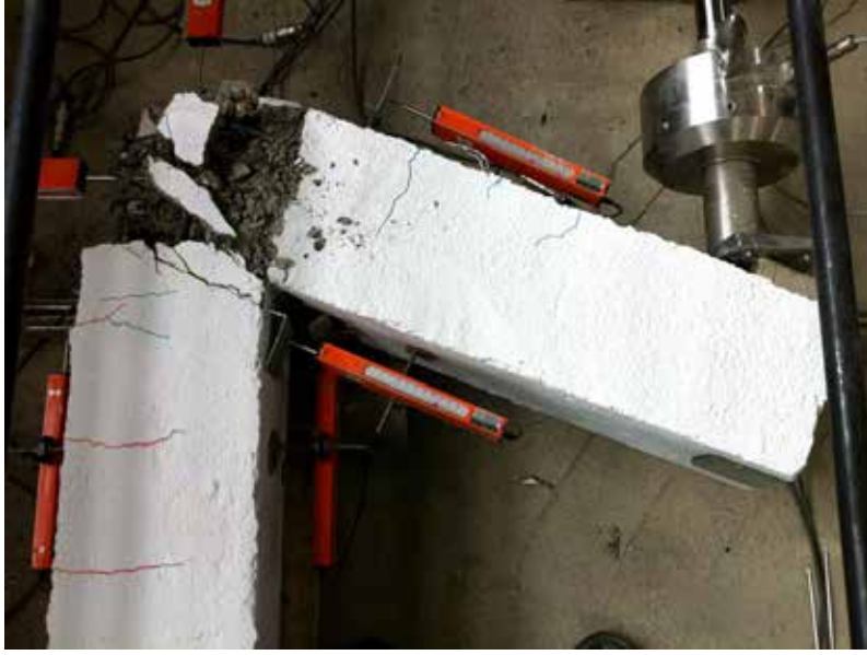
Şekil 9. TS numunesinin göçme sonrasındaki görünüşü
