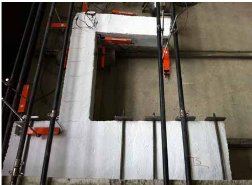
Şekil 8. TS numunesinin göçme anındaki görünüşü
