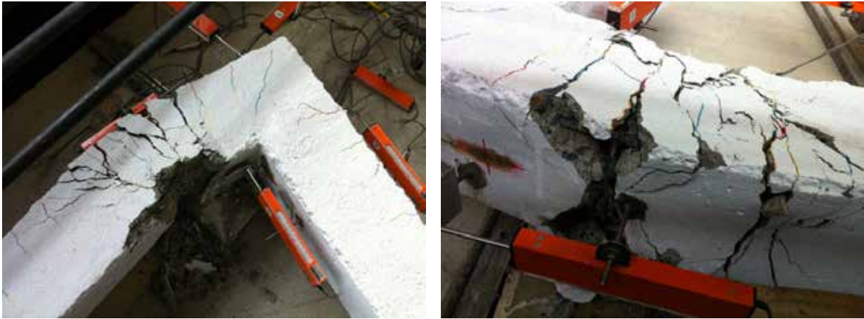
Şekil 11. STM numunesinin göçme sonrasındaki görünüşü
