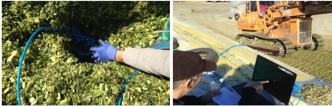
Şekil 4. Basınç algılayıcıların yerleştirilmesi, veri toplama ve depolama
