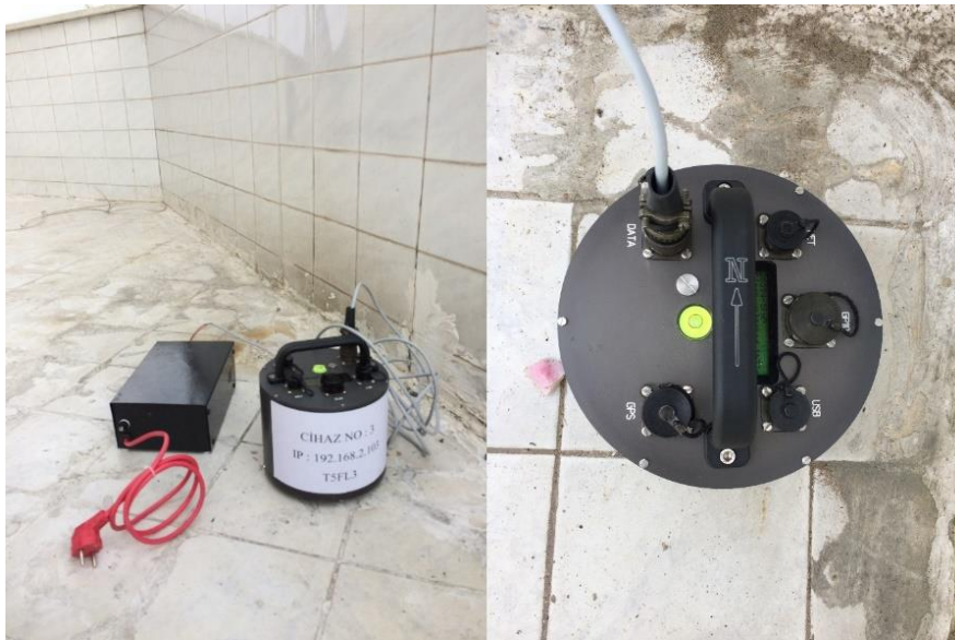
Şekil 5. Binada ivmeölçerlerle tespit
