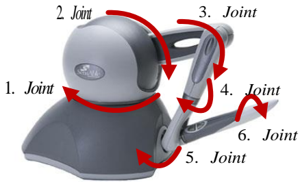
Şekil 1. Phantom Omni Haptik robot ve dönme eksenleri[7]
