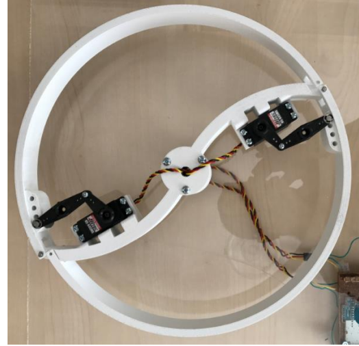
Şekil 3. SLEGS robotun bacağının “O” şeklindeki resmi
