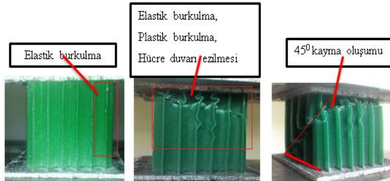
Şekil.16. 7 mm hücre boyutu ve 40 mm hücre yüksekliğine sahip PLA termoplastik petek yapıli kompozit numunenin deney aşamalarına göre hasar durumları
