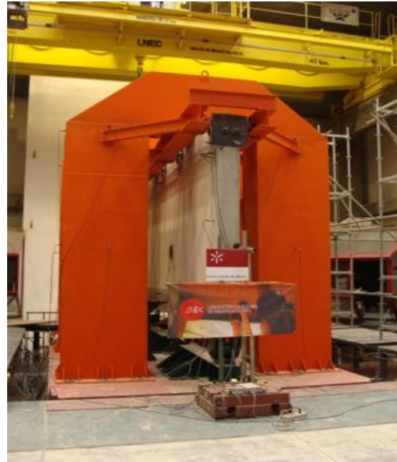
Şekil 3. Deney öncesi numune, sarsma tablası ve çelik destekler [28,39]
