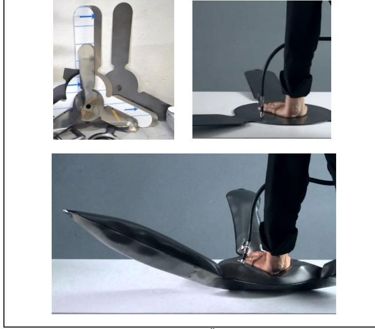
Şekil 5. Tek Bir Modül Halinde Üretilen Plopp Tabure (URL4)
