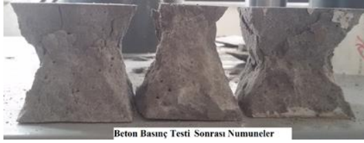
Şekil 4. Basınç testi sonrası numunelerin görüntüsü (The view of the samples after being subjected to compressive strength test)
