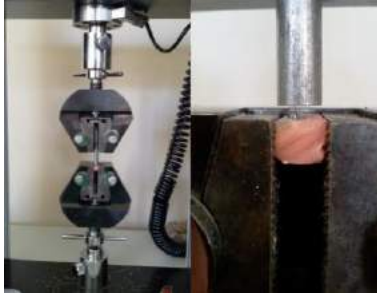
Şekil 2. Biyomekanik analiz için kullanılan cihaz ve basma testi uygulanması.
