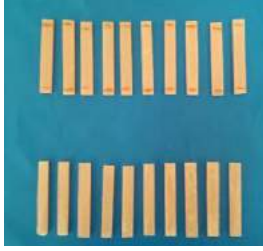
Resim 2: Testler için hazır hale getirilmiş akrilik örnekler
