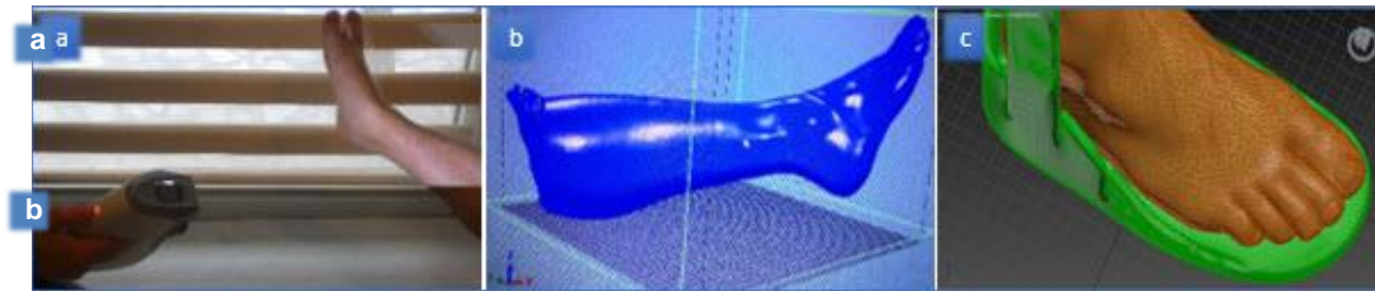
Şekil 9. a) 3b tarama işlemi (3d scanning process), b) Referans hedef uzvun anatomisi (3d model of target limb anatomy), c) Ortez tasarımının hasta anatomisine göre şekillendirilerek uygulanması (Customization of the model)
