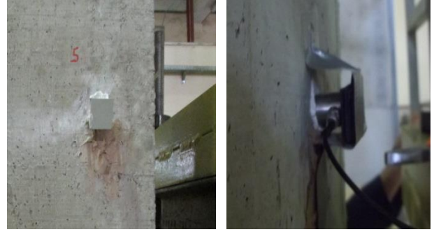
Şekil 8. AE sensörlerinin yerleşimi (The layout of the AE sensors)
