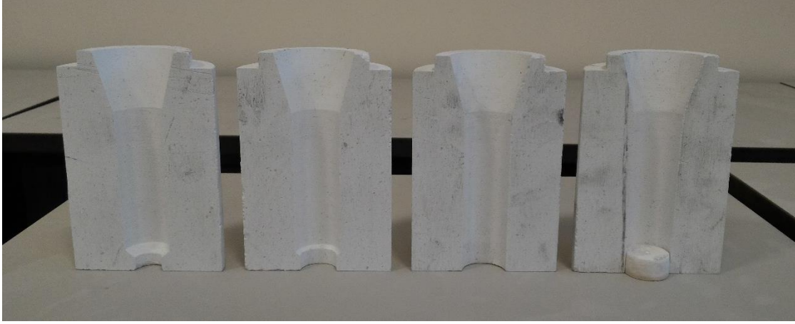
Şekil 2. Farklı soğuma hızlarının elde edilmesi için kullanılan seramik iç katmanlar (Ceramic inner layers that used for obtaining different cooling rates)
