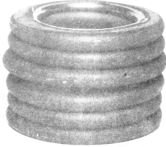
Şekil 1. Boruların aksenal yük altında yuvarlak yüzeyli halkalar oluşturarak buruşması.
