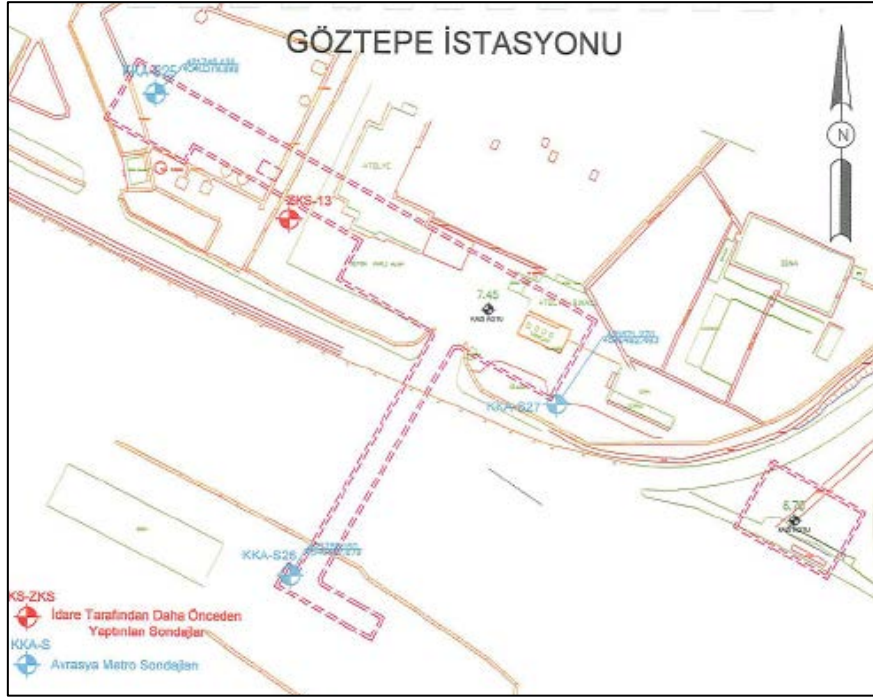
Şekil 2. Göztepe İstasyon alanı araştırma sondaj lokasyonları.
