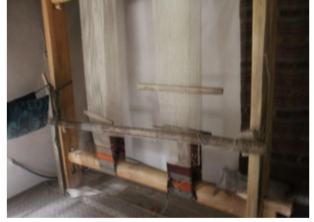
Foto 8. Soruh Vadisi'ndeki köylerde kullanılan "Düzen" adı verilen dokuma tezgahı detayı.
