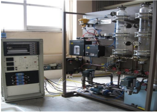
Şekil 1. Kablosuz proses kontrol amacı ile geliştirilen proses simülatorü (Process simulator developed with wireless process control purpose)
