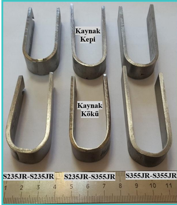
Şekil 4. Eğme testi sonucu kaynak görselleri (The welding images after bending test).
