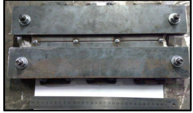
Şekil 1. Kaynak işlemlerinde kullanılan kalıp (The fixture in the welding process).
