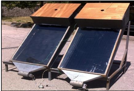
Şekil 2. Düz ve hapsedici yüzeyli kurutma fırınları (Straight and incarceration surface drying ovens)
