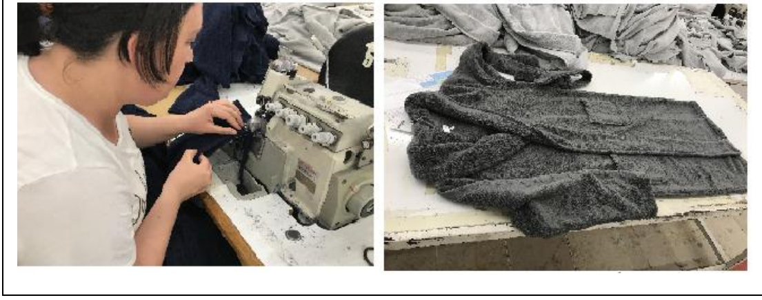
Şekil 3. Yan birleştirme işlemi ve dikilen bornoz modeli
