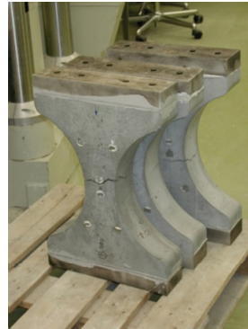
Şekil 2.1 - Tek eksenli çekme deneyi için hazırlanmış kemik numunelerin biçim ve boyutları.
