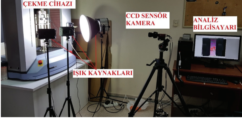
Şekil 3.4 - Çekme deneyinde kullanılan DIC deney düzeneği
