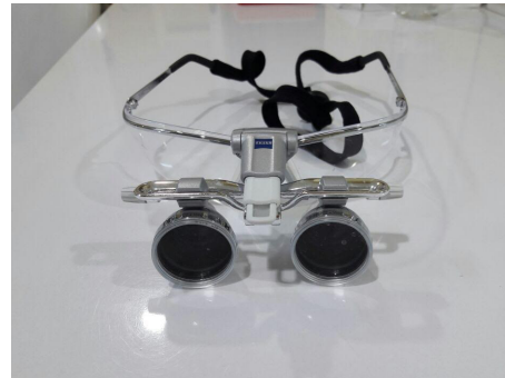
Resim 2. Prizmatik büyüteç (ZEISS EyeMag Smart x2.5) (Anabilim dalımızda kullanılan prizmatik büyüteç örneğidir)
