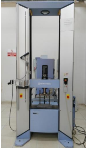
Şekil 3. Shimadzu AG-X çekme-basma üniversal test cihazı
