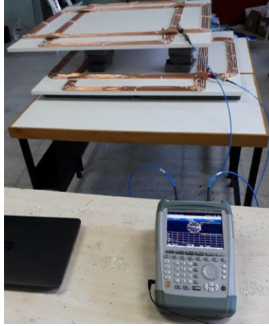
Şekil 4. Laboratuvar ortamında 2-portlu S-parametre ölçüm düzeneği.
