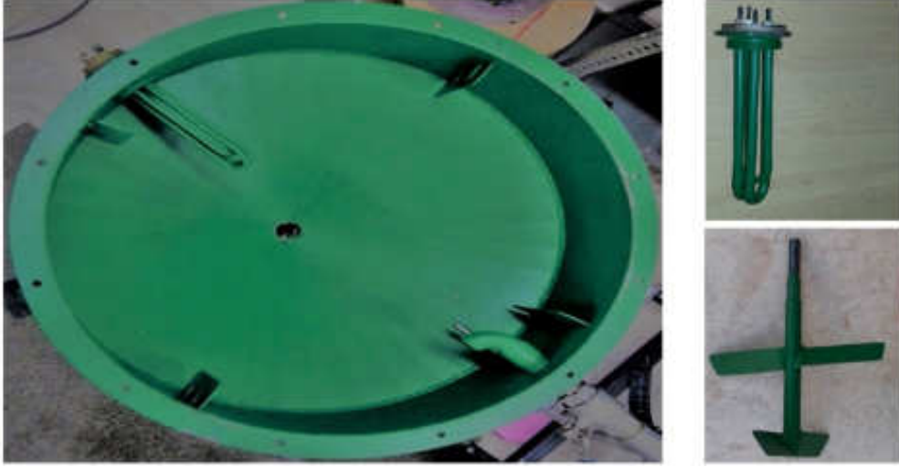
Şekil 3. Teflon malzeme ile kaplanan reaktör iç hacmi ve bileşenleri.
