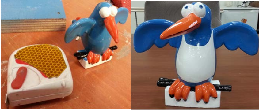
Şekil 5. 3B yazıcı ile üretilen ve boyanan iki adet heykel replikası.
