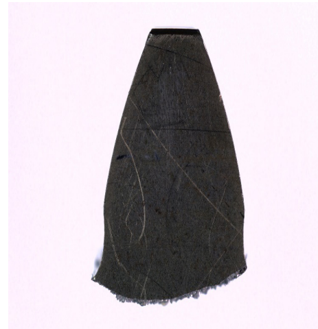
Şekil 14. Silindirik düz dişli çarkın dişinin hasar görünümü
