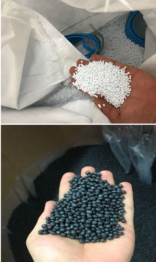
Şekil 1. Deneyel çalışmada kullanılan granül haldeki PE + EVA karışımı malzeme.
