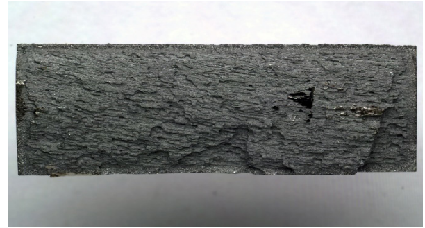
Şekil 13. Bir bilye-püskürtülmemiş, yüksek-sertlikli dişli çarkın dişinin kırılma yüzeyi
