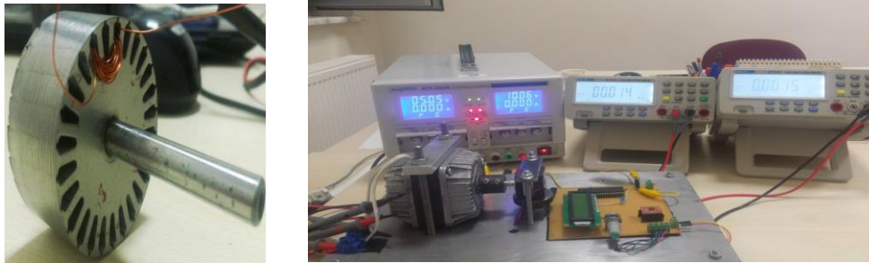
Şekil-1 Sincap kafesli rotor ve deney düzeneği
