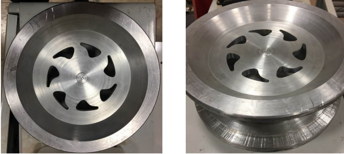
Şekil 4: İşlenmiş Alüminyum jant örnekleri
