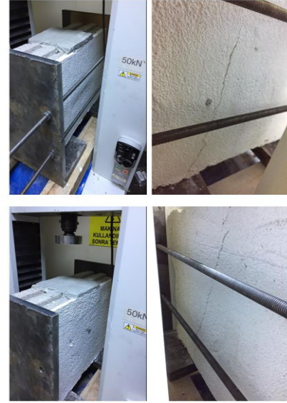
Şekil 16. D31G03-2 ve D31G03-3 numunelerinin deney öncesi ve sonrasındaki durumu
