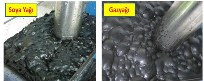
Şekil 2. Soya yağı ve gazyağının agloflotasyon anı görüntüleri
