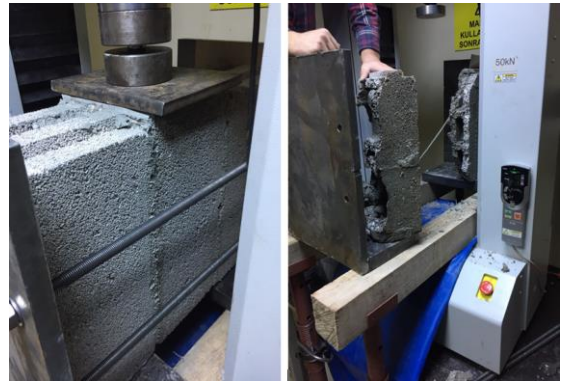
Şekil 9. D3R00 grubuna ait 1. numunenin deney öncesi ve sonrasındaki durumu
