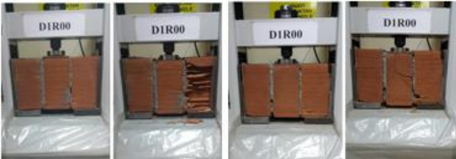
Şekil 7. D1R00 grubuna ait 2. ve 3. numunelerin deney öncesi ve sonrasındaki durumu
