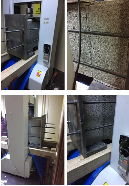
Şekil 10. D3R00 grubuna ait 2. ve 3. numunelerin deney öncesi ve sonrasındaki durumu
