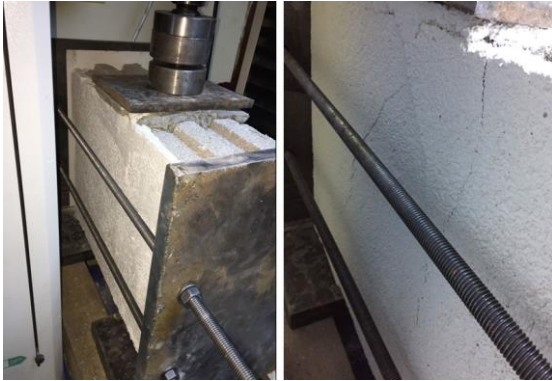
Şekil 15. D31G03 setine ait ilk numunenin deney öncesi ve sonrasındaki durumu
