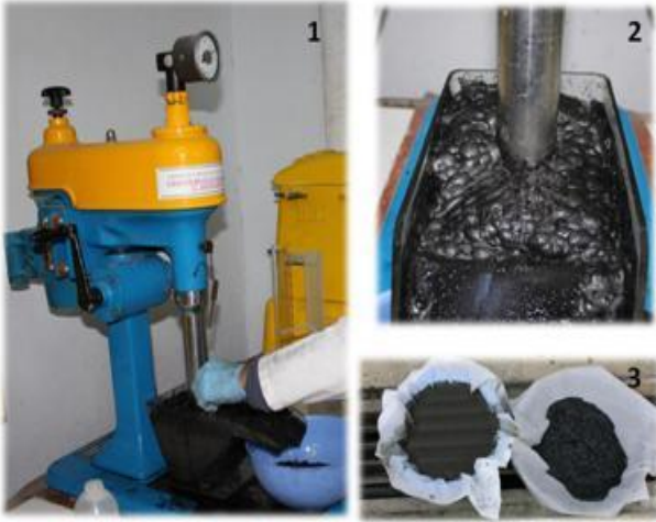
Şekil 1. Agloflotasyon deney düzeneği ve elde edilen ürünlerin görüntüleri [2]
