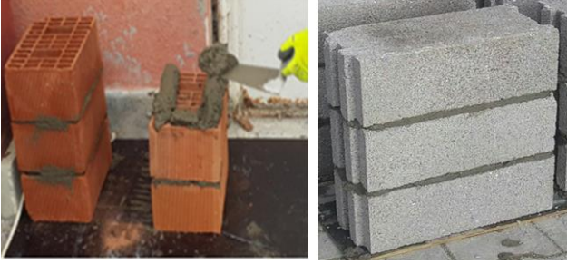
Şekil 2. Deneysel çalışmada kullanılan üçlü test numuneleri
