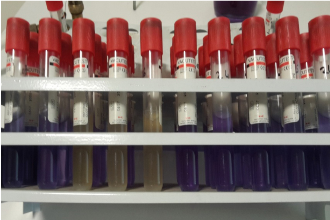
Şekil 3. MacConkey Broth kullanılarak dondurma numunelerinde koliform varlığının belirlenmesi
