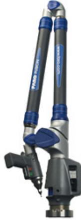
Şekil 1-Üç Boyutlu Taramada Kullanılan Faro Fusion Cihazı [3]
