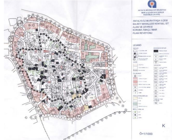
Resim 1: Balbey Mahallesi Kentsel Sit Alanı ve Çevresi Koruma Amaçlı İmar Planı paftası (Cumhuriyet dönemi konutları pafta lejantında C ile simgelenmiş, ayrıca yazar tarafından sarı ile gösterilmiştir. (Kaynak: Antalya B.B. KUDEB ofisi).
