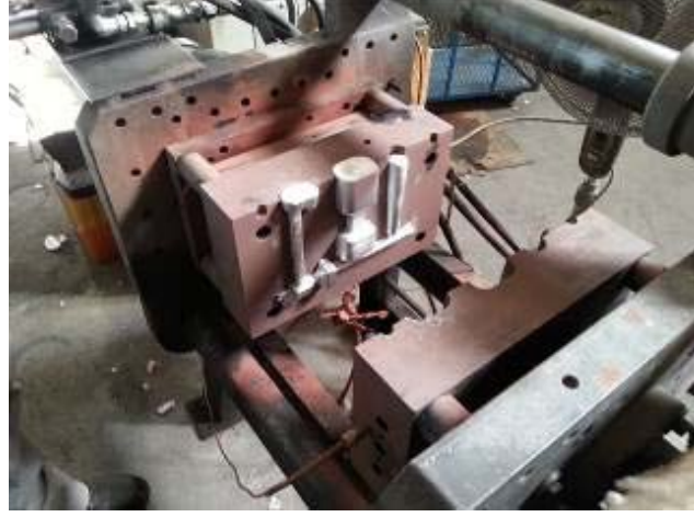
Şekil 2. Kokil kalıba döküm sonrası kalıp görüntüsü.
