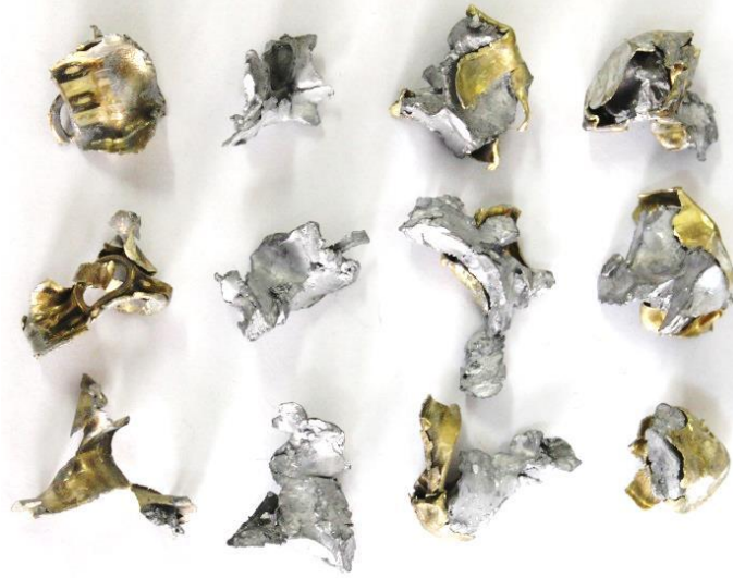
Şekil 6. 9x19 mm mermi deformasyon görüntüleri.
