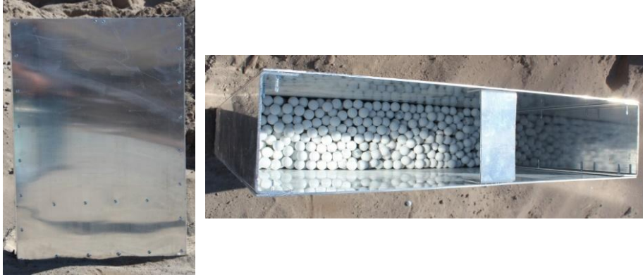
Şekil 2. Al dış duvar ve porselen iç parçacıklar kullanılarak tasarlanmış modüler zırh sistem.
