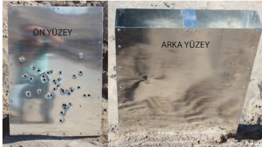
Şekil 5. 9x19 mm parabellum tabanca mermisi isabeti sonrası zırh sistemi ön ve arka yüzey görüntüleri.
