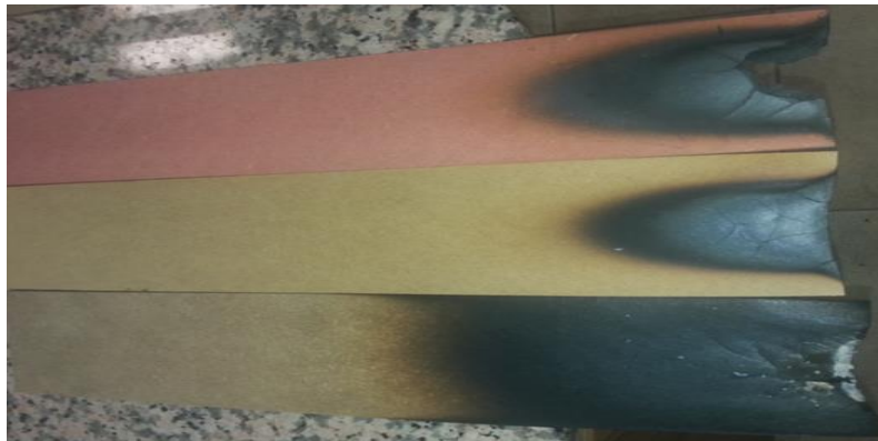
Şekil 5. 18 mm boyalı, boyasız ve kontrol numunelerinde yanma dayanım testi sonrasındaki görünüm.
