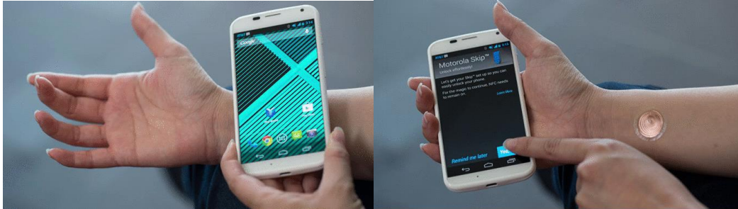
Şekil 7: Dijital Dövme'yi başlatan Motorola, telefonu hızlı bir dokunuşla açan NFC (kablosuz iletişim teknolojisi) tabanlı bir cilt etiketi kullanıyor (URL 8).
