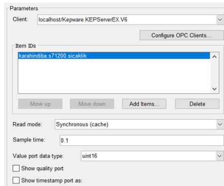
Fig. 17. Matlab/Simulink OPC Configuration
