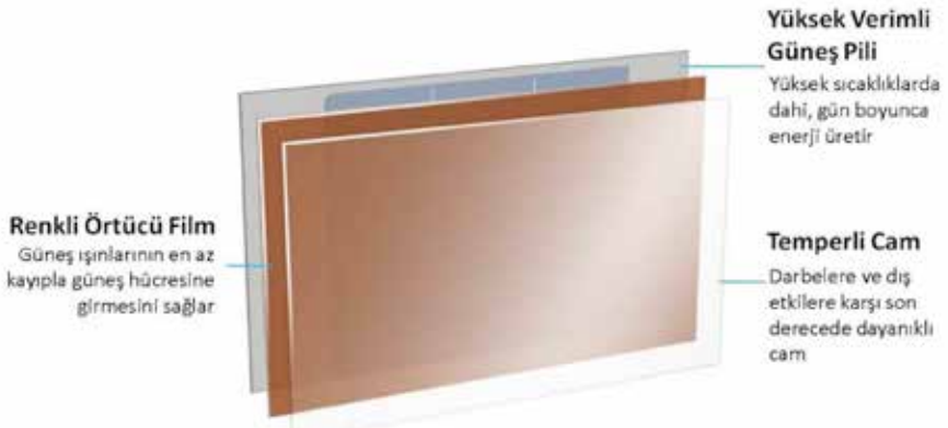
Şekil 4.6: Güneş enerjisi üreten çatı kaplama malzemelerinin anatomisi [25].
