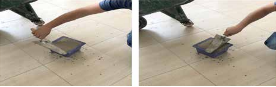
Şekil 3. Betonun kalıba yerleştirilmesi
