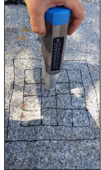
řekil 1: Kaya yüzey sertlik lümleri için bu alıřmada kullanılan “DRC ECTHA 1500 Kaya Test ekici” ve lüm řablonu.
