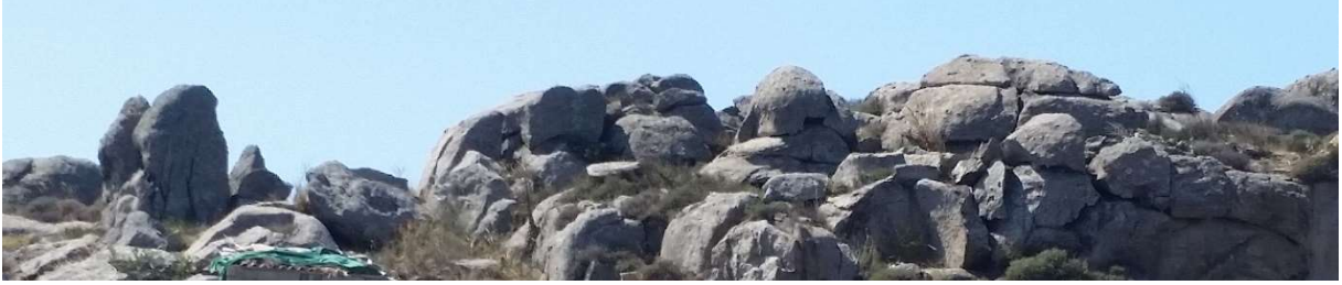
Foto 2: Schmidt çekici Geri Tepme deęeri R: 40-50 aralıęında olan ölçümlerin yapıldığı, Tablo 1 de sertlik derecesi 3 (orta) olarak tanımlanan granit kaya yüzey örnekleri.
