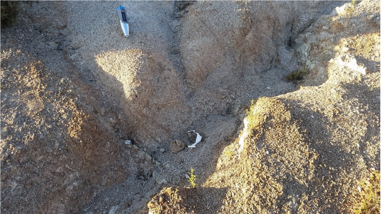
Foto 6: Geri tepme deđeri R: 17-25 aralıđında olan lmlerin yapıldıđı, Tablo 1 de sertlik derecesi 5 (ok zayıf) olarak tanımlanan grubun alt sınır rneklerine ait az eđimli yamalara ait granit kaya yzeyleri. Yarıntı erozyonunun yaygınlıđı ve derin yarıntı kanallarındaki arena birikimleri dikkat ekici řekilde yaygındır.
