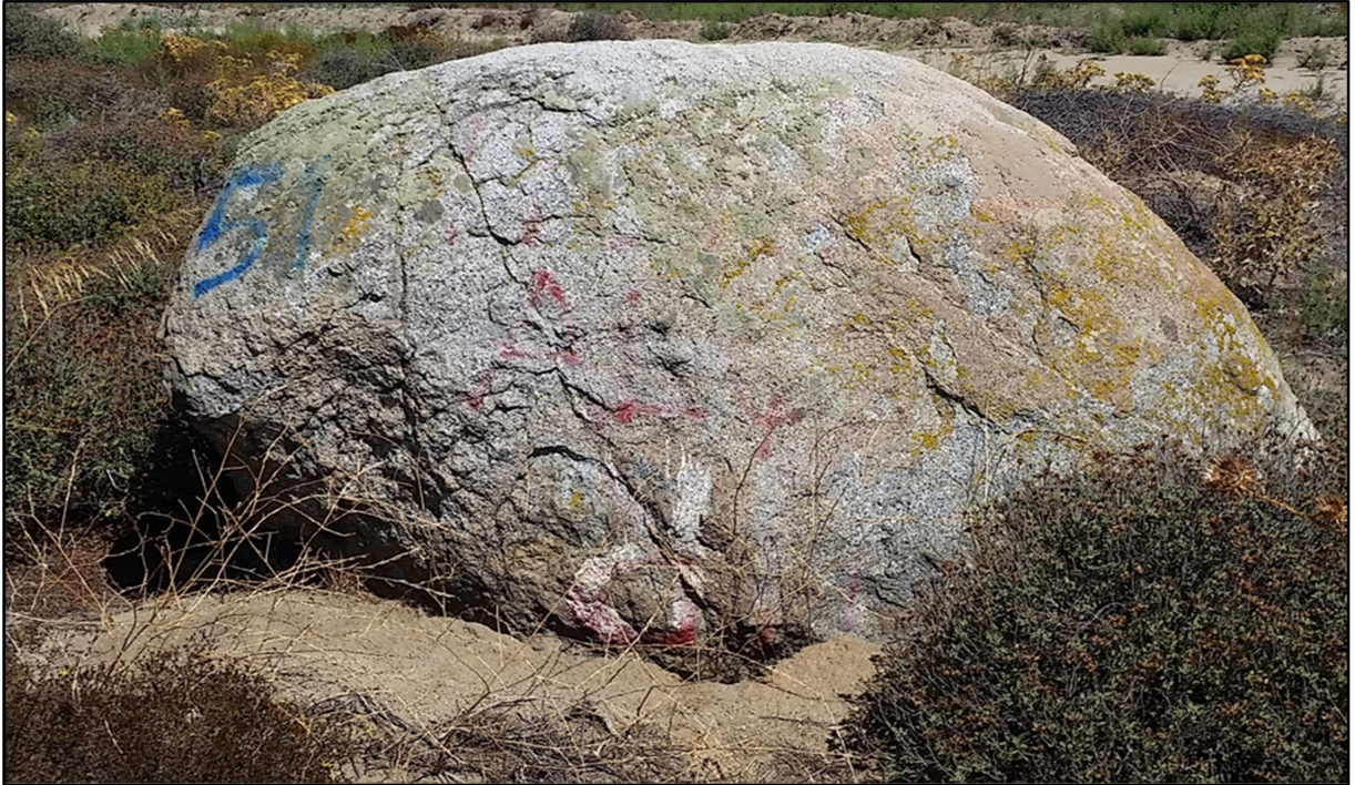
Foto 4: Bu fotodaki örnekte de olduęu gibi eksfoliasyon gözlemlenen granit yüzeylerde; geri tepme deęeri düşük, A, S, P deęerleri ise yüksek çıkmıştır.
