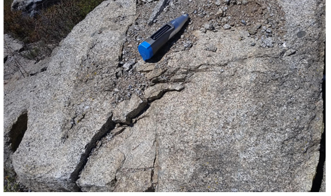
Foto 2: Schmidt çekici Geri Tepme deęeri R: 40-50 aralıęında olan ölçümlerin yapıldığı, Tablo 1 de sertlik derecesi 3 (orta) olarak tanımlanan granit kaya yüzey örnekleri.
