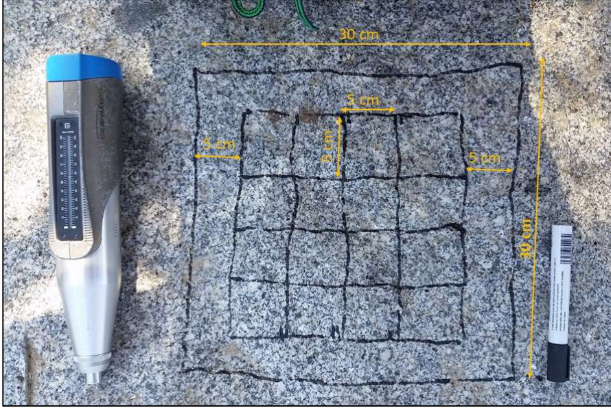
řekil 1: Kaya yüzey sertlik lümleri için bu alıřmada kullanılan “DRC ECTHA 1500 Kaya Test ekici” ve lüm řablonu.
