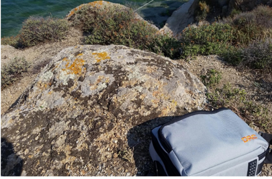
Foto 5: Likenli granit yüzeylerde R_o = 32,00-33,63 arası çıkması; bu durumdaki kaya yüzeylerinin aşınma karşı direncin "Zayıf-Çok Zayıf" sınırına işaret etmektedir.
