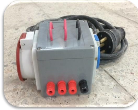
Şekil 3. 3 faz bağlantı aparatı Figure 3. 3 phase connection aparate
