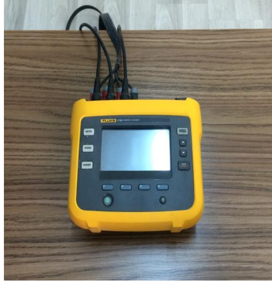
Şekil 2. 3 fazlı güç analizörü
