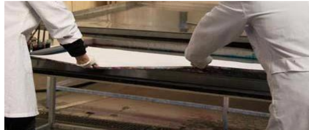
Resim 19. Halının boyayı emdikten sonra teknedeki çıkartılması işlemi
