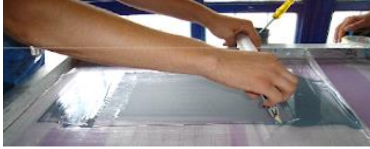
Resim 8. İpek baskı tekniği, Kasnak ve ragle.
