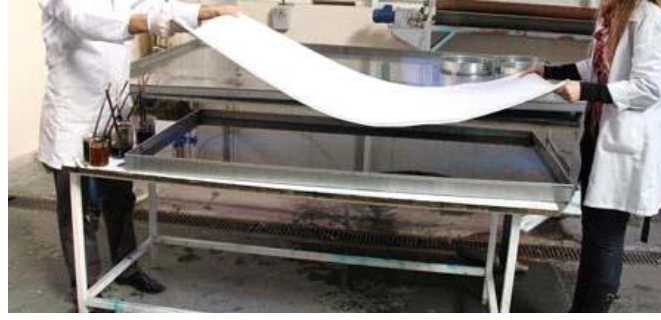
Resim 17. Düz renkli akrilik halının tekne içine yerleştirilmesi
