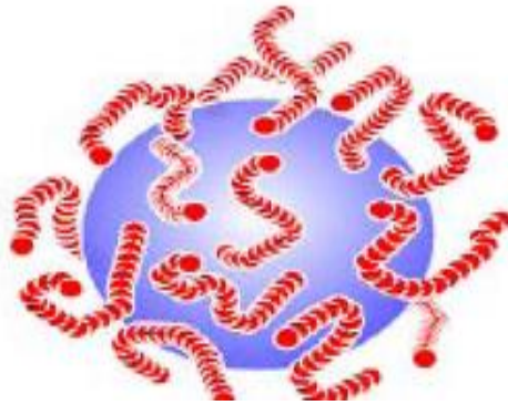
Şekil 2. Dağılma etkisi-Sterik etki (Dispersion Effect-Steric effect)
