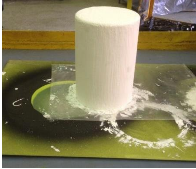
Şekil 15. Hafıza Modülünün Isı Sırasında Şişen Boya İle Kaplanması
