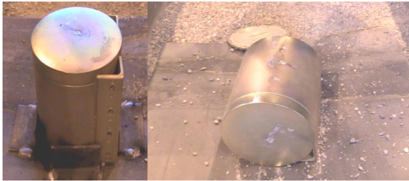
Şekil 11. Düşey ve yatay konumda yapılan test sonucunda deforme olmuş numune
