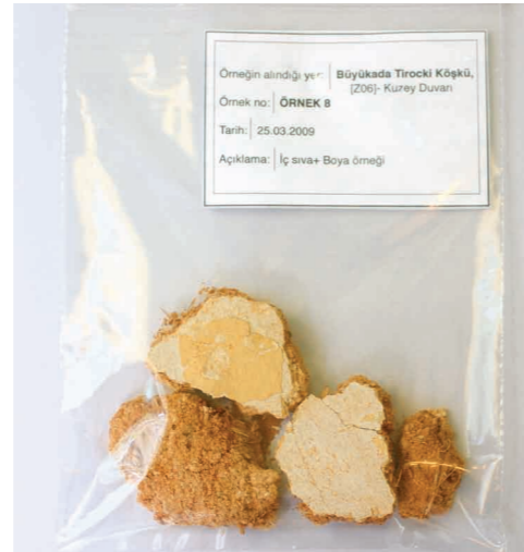
F.5: Örnek alımı, fotoğraflama, sınıflandırma ve arşiv (KUDEB Rest. ve Kons. Lab., 2009)
