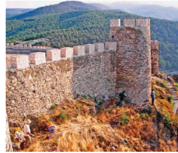
Resim 16: Sinop Boyabat Kalesi sismik kırılma etüdü
