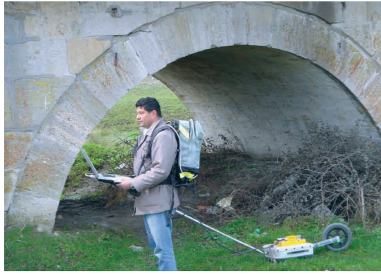
Resim 5, Edirne-Uzunköprü ilçesi Uzunköprüde GPR etüdü.
