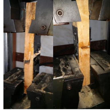
Şekil 3. Çekme deneyine tabi tutulmuş kertmeli ve uç uca boy birleştirme numuneleri
