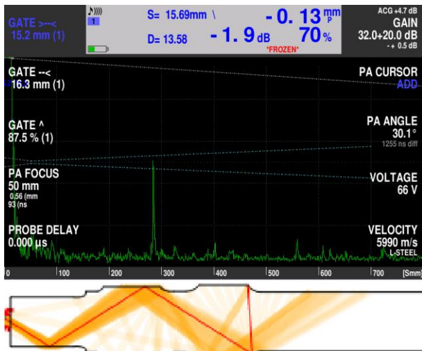
Şekil 24. 30° prop ile ultrasonik muayene görüntüsü ve şematik gösterimi.
