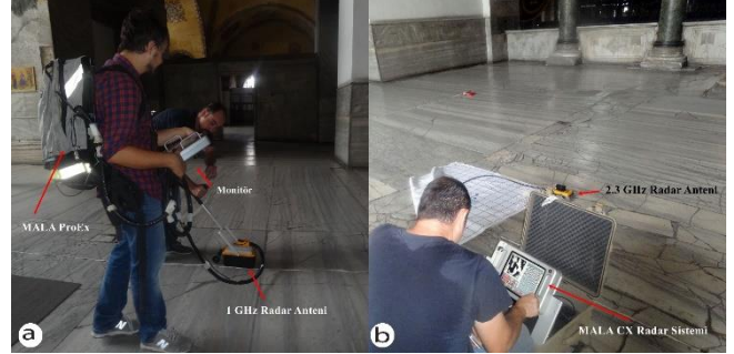
Şekil 4. a) 1 GHz antenli Mala RAMAC ProEx GPR sistemi, b) 2.3 GHz antenli Mala CX Radar sistemi
