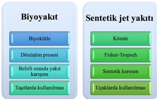
Şekil 5: Biyoyakıt ve sentetik jet yakıtı üretimi
