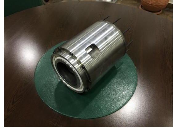
Şekil 5: Üretilen Pars türbojet motor (yanma odası gösterilmemektedir). Beyaz: seramik rulmanlar. Yan hava deliği havayı teğetsel olarak kepeçleyerek ve fazladan basınçlandırarak içeri almaktadır.
