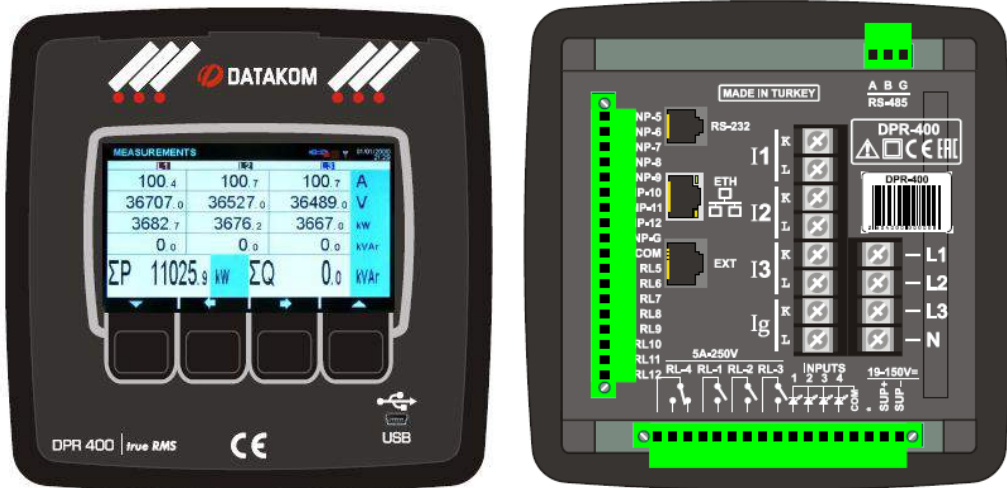
Şekil 3. Dijital koruma rölesinin ön ve arka yüzden görünümü
