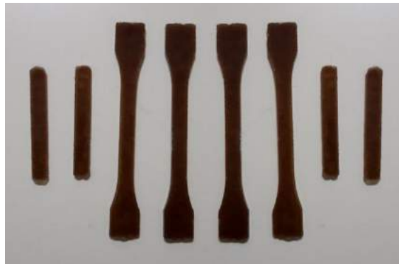
Şekil 2. Teflon kalıptaki numuneler
