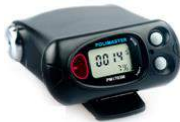
Şekil 2. Deneysel ölçüm için kullanılan gama dedektörü (Polimaster 1703mo-1b)
