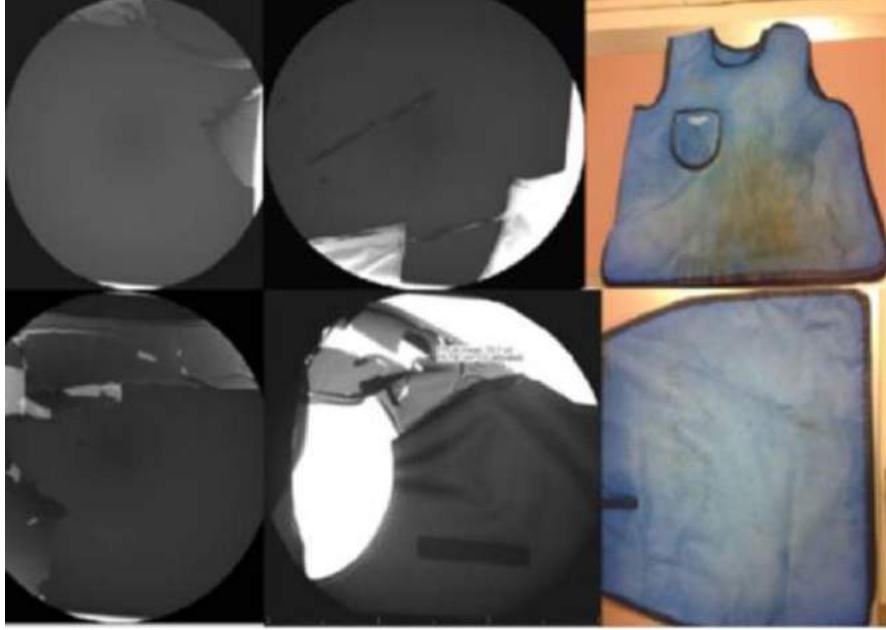
Şekil 4: Atık kararı alınan 7 adet delik/yırtık olan etek-yelek kurşun koruyucu giysi
