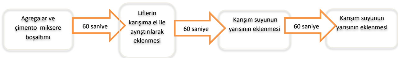
Şekil 3. Beton karışımı hazırlama prosedürü
