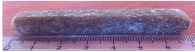
Şekil 2. İşlenmiş çentiksiz üç nokta eğme numunesi
