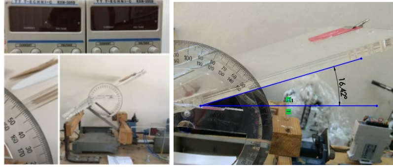
Şekil 1. Statik sürtünme katsayısının belirlenmesinde kullanılan düzenek
